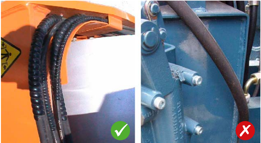
Abb. 11 Vermeidung von Abknicken oder Scheuern
