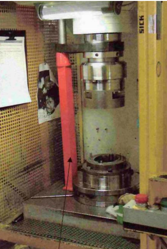
Abb. 28 Eingesetzte Abstützung an einer hydraulischen Presse
