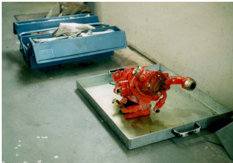
Abb. 19 Mobilhydraulik- pumpe in einer Ölauffangwanne
