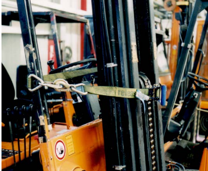
Abb. 36 Festgezurrtes Hubgerüst bei Arbeiten an Neigezylindern
