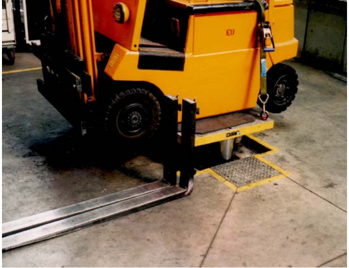
Abb. 35 Demontierte Hubgabeln bei Arbeiten an der Staplerhydraulik
