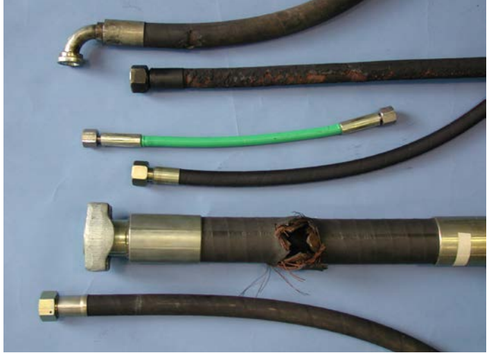
Abb. 16 Beispiele ausgefallener Hydraulik- Schlauchleitungen
