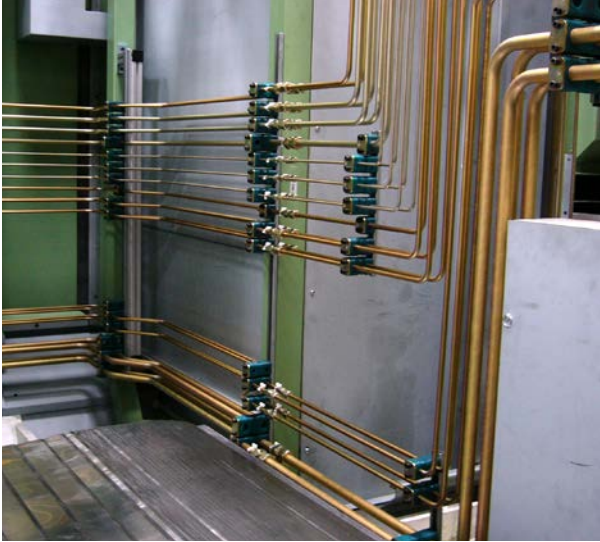
Abb. 10 Fachgerechte Befestigung von Rohrleitungen mit Leitungshalterungen
