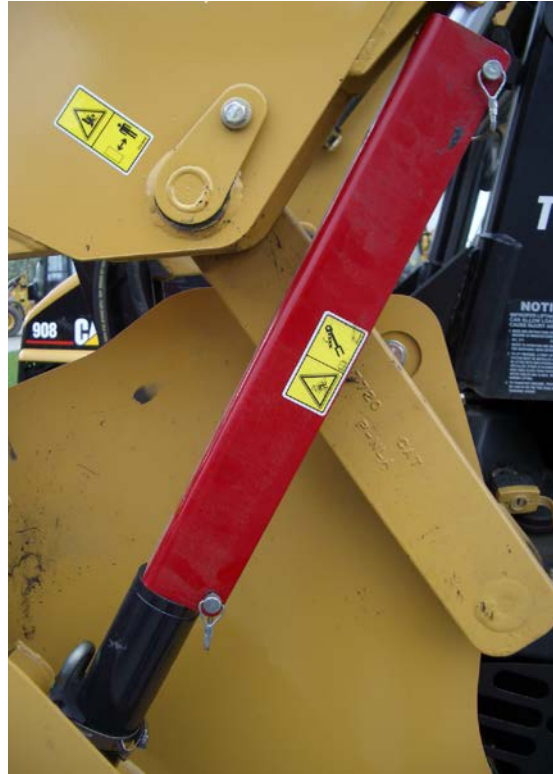
Abb. 41 Stützeinrichtung in Position an einer Erdbaumaschine
