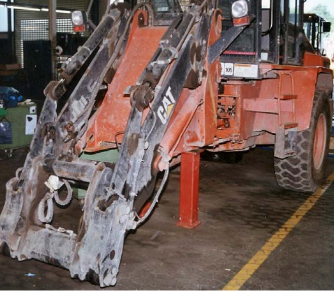
Abb. 33 Unterbaugestell bei Arbeiten am Radlader
