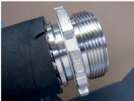
Schlauchstutzen bis zum Stutzenbund in den Schlauch drücken (evtl. mit Wasser oder Fett als Gleitmittel).
