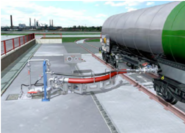
Abbildung 16a: Verlegen von Schlauch leitungen – Schlauchgelenkarm
