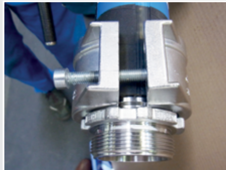
Klemmbacken mit zwei längeren Montagehilfsschrauben über Kreuz verschrauben.
