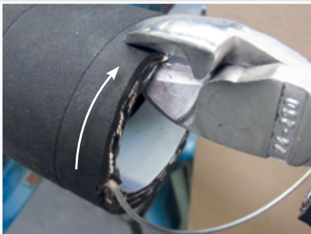
Stahldrahtwendel mit dem Seitenschneider trennen. Abstand ca. 90° vom Austritt entfernt.
