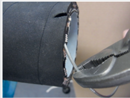
Stahldrahtwendel mit Zange aus der Schlauchwand herausziehen.
